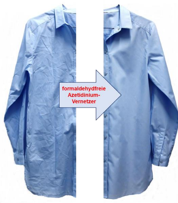
Abbildung 1: Knitterfreiausrüstung von Cellulosefaser-Textilien mit neuen formaldehydfreien Vernetzern
