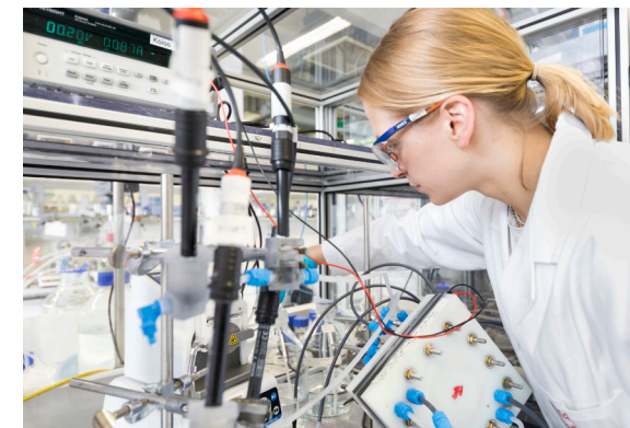
Aufbau einer Anlage zur kapazitiven Entsalzung mit Durchflusselektroden (FCDI). FCDI ist eine innovative elektrochemische Technologie zur Ionen-Wasser-Trennung mit hoher Wasserrückgewinnungsrate und kann vollständig mittels erneuerbarer Energie betrieben werden.
